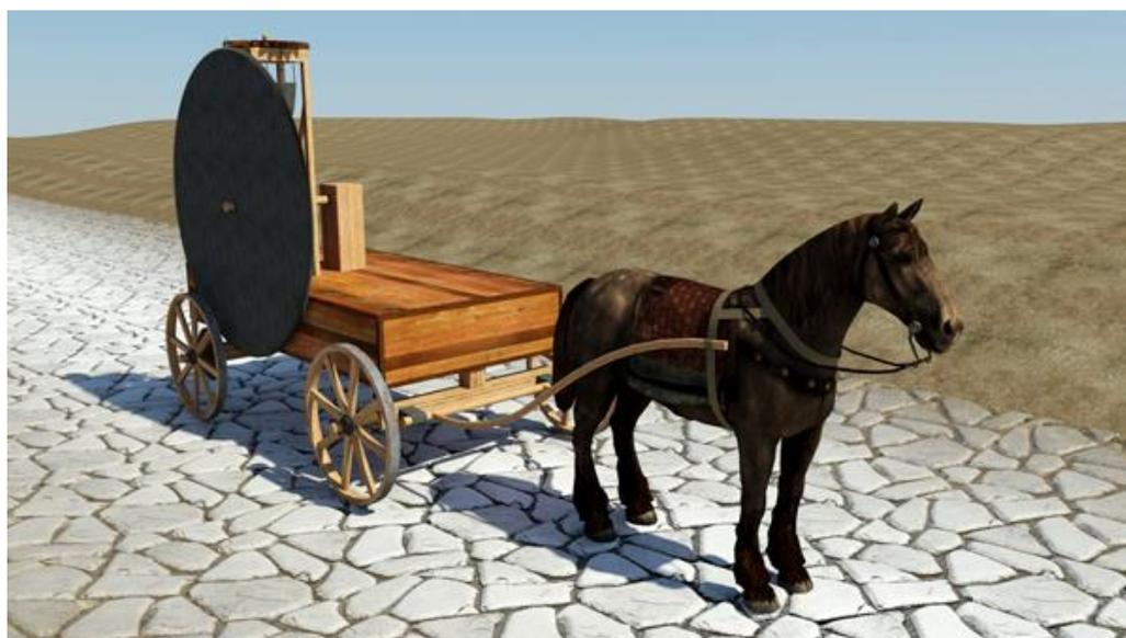
Les distances étaient mesurées à l'aide d'un odomètre<sup>21</sup>. Une roue, en contact direct avec le sol, tourne et entraîne un plateau horizontal par l'intermédiaire de pignons. Ce plateau comporte des cases dont chacune contient une bille ou un caillou ; à une position donnée,
