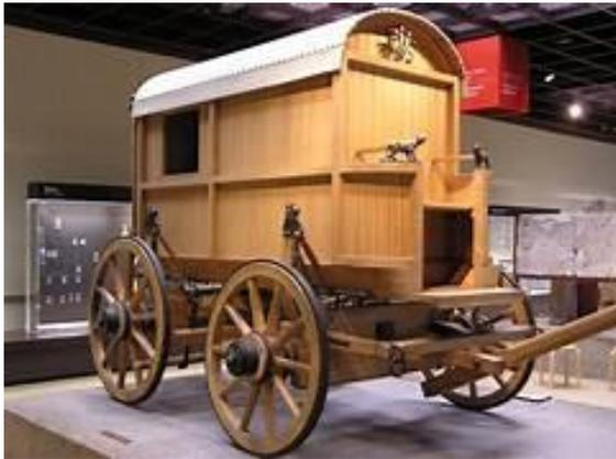
Un modèle a été restitué au musée de Cologne avec ses décors et son système de suspension : le châssis du char est tenu par des courroies de cuir. On sait toutefois
